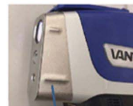
日本仕様は先端部を真鍮カバーにして遮蔽強化
