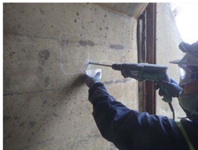
試料採取状況 ドリル(Φ14mm)で表面から10mm程度の深さまでのドリル粉を採取した。
