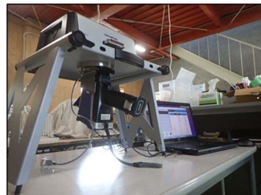
使用装置：オリンパス社製ハンドヘルド 蛍光X線分析装置
